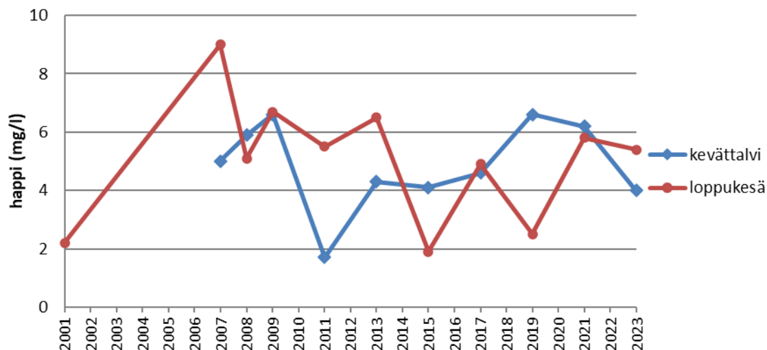
Kuva 36. Iso-Tiilijärven happipitoisuus (mg/l) alusvedessä (13–15 m) kevätlälvellä ja loppukesällä vuosina 2001–2023.
